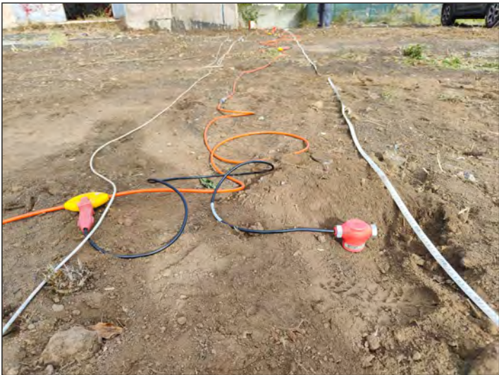
Figura 1.4: TMS-1 / MW-1: Dettaglio Geofono
