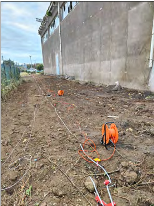
Figura 1.2: TMS-1 / MW-1: Array dei geofoni fotografato dal Lato B
